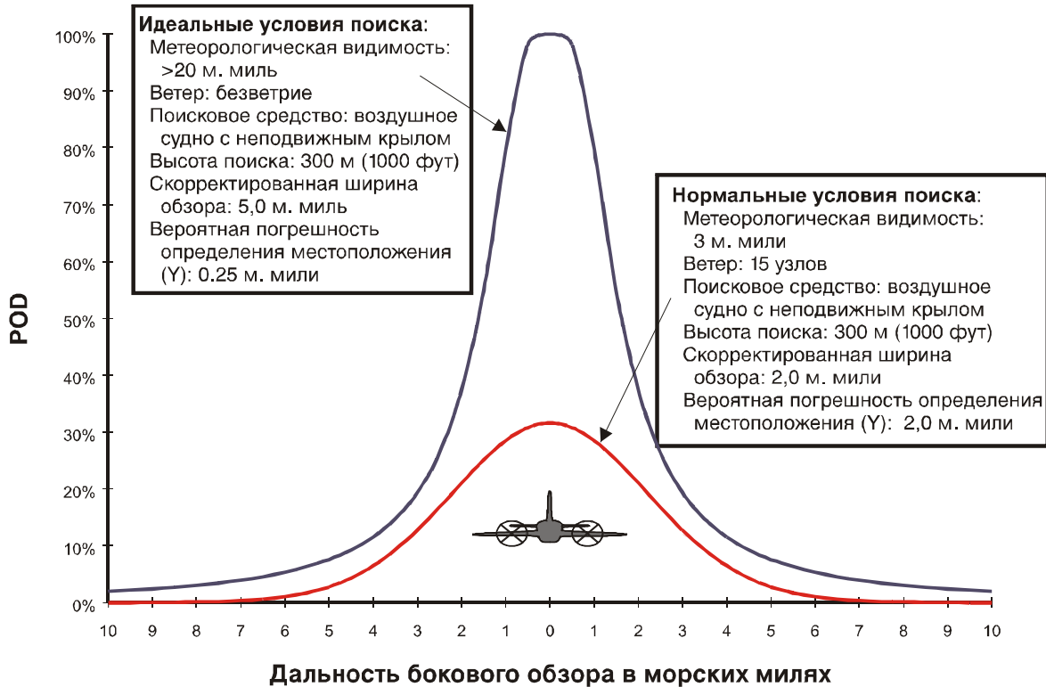
Рис. 4-13. Пример кривых вероятности обнаружения при визуальном поиске за один проход [объект поиска: шляпка длиной 7 м (23 фут)]
